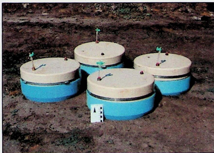
Figura 3 – Câmaras estáticas utilizadas na amostragem de fluxo de gases para atmosfera.
