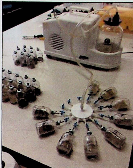
Figura 4 – Frascos de vidro ( vials ) com 15 g de folhelho pulverizado em frações menores do que 25 mm ligados a uma bomba de vácuo.
